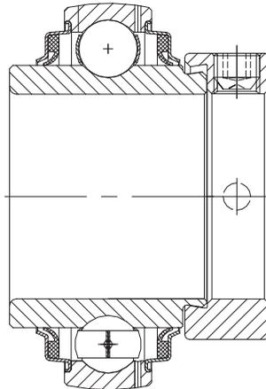
Abb. 6: NKE Gehäuselager, Bauform GE
