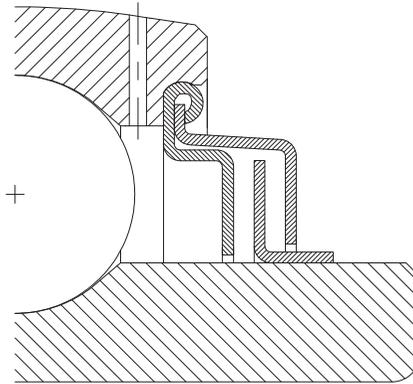
Abb. 11: NKE Gehäuselagerdichtung, Bauform L
