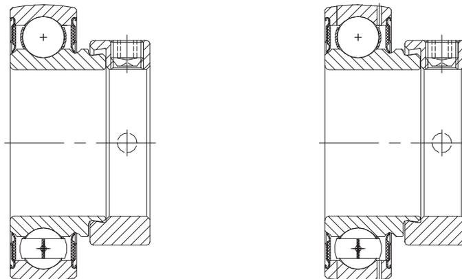
Abb. 7: NKE Gehäuselager, Bauformen RAE und GRAE
