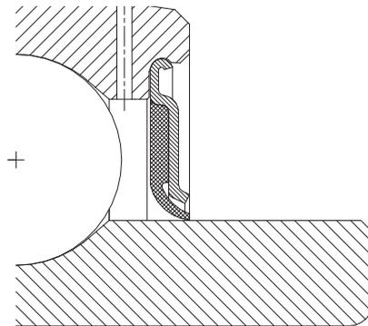
Abb. 8: NKE Gehäuselagerdichtung, Bauform **P**
