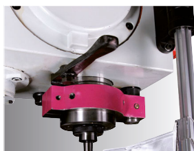
Vyražeč usnadňuje výměnu nástrojů
