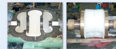
Oprava opotřebovaného a zkorodovaného hřídele pomocí Supertmelu Loctite® 3478. Po jeho vytvrzení se dokončila celková úprava stroje. Všechny části byly natřeny keramickým nátěrem Loctite® Nordbak® 7228 – bílý (produkt je certifikován pro kontakt s pitnou vodou).
