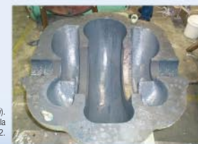
Loctite® Nordbak® 7227 keramický nátěr (šedý). Zkorodovaná místa se vyplnila a vyrovnala pomocí tmelu proti opotřebení Loctite® 7222.
