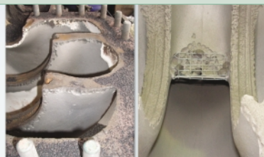
Pitting a eroze povrchu jsou zcela viditelné
