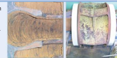
Horní víko a bronzové oběžné kolo před opravou. Prvním krokem je otryskání těchto částí na hodnotu SA-3 – bílý kov, a na houbku profilu 75 µm.
