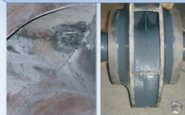
Oběžné kolo a těleso před opravou. Značné poškození a kavitace na oběžném kole.
