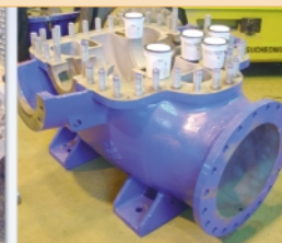
Obr. 2: Povrchy byly tryskané až do dosažení hloubky profilu povrchu 75 µm
