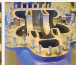
Obr. 4: Celkový nátěr první vrstvou a po jeho částečném vytvrzení nanesení druhé vrstvy
