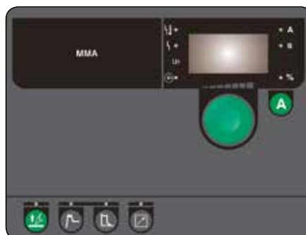
Pi MMA Ovládací panel stroje pro svařování metodou MMA s volitelně doplňitelným postupem TIG kombinovaným s jednoduchým zapalováním pomocí funkce LIFTIG®
