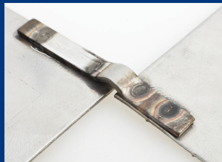
Bodování – nerez 1 mm / nerez 1,5 mm
