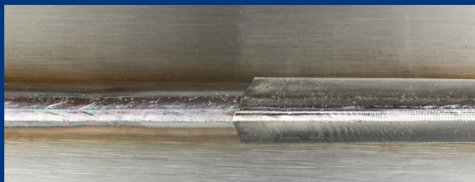
Koutový svar - nerez 1,2 mm / nerez 1,2 mm (s přídavným materiálem) / očištěný laserem
