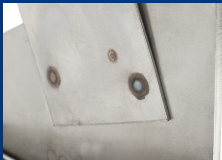
Bodování – nerez 1 mm / nerez 4 mm
