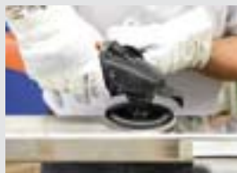
Pracovní krok 2-4: Brusný list Pyramix A 45, A 30 a A 16 (doporučené otáčky 4200/min, zde stupeň 3).
