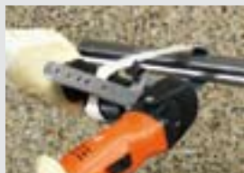
Pracovní krok 1: Tvorba výbrusu s brusným pásem zrn 120 (doporučené otáčky 1500/min, zde stupeň 2-3).
