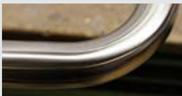
Výsledek: Díky elastickému finišovacímu kotouči nevznikají i přes rotační postup na povrchu žádné stopy rotačního broušení.
