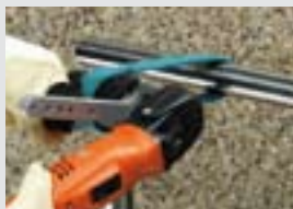
Pracovní krok 2: Tvorba výbrusu s rounovým pásem středním (doporučené otáčky 2200/min, zde stupeň 3).
