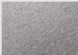
Výchozí situace: Za tepla válcovaný povrch z ušlechtilé oceli.
