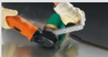
Použití: úběr svaru s brusným pouzdem a expanzním válcem s maximálními otáčkami 2500/min (zde stupeň 6).
