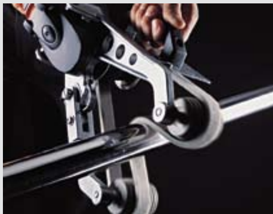
Vysoce lesklý povrch trubky z ušlechtilé oceli pomocí brusky na trubky RS 12-70 E.
