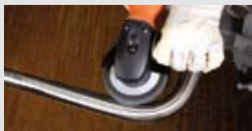
Použití: Konečný finiš s finišovacím kotoučem Ø 125 mm (doporučené otáčky 3300–4200/min, zde stupeň 2 - 3).
