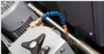
Pracovní krok 2: Finiš se satinovacím brusným pásem GRIT v kombinaci s chlazením a mazáním (doporučené otáčky 1500/min, zde stupeň 1).
